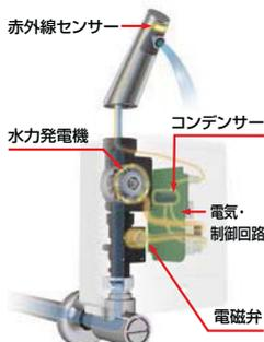
吐水のパワーを電気エネルギーに変える「アクエナジー」方式。自動水栓の作動電源を自己発電でまかなう先進技術です。
